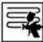
Aplicar 2 a 3 passadas com intervalo de 5 a 7 min entre passadas.
